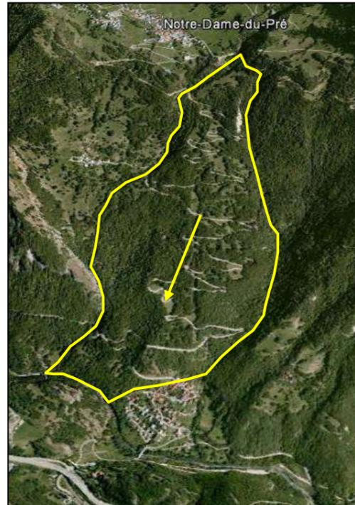
Figure 1 : Glissement du Grand Clapet [Source : Google Earth / IMS<sub>RN</sub>]
